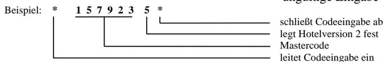
**Programm 6: Programmierung und Löschung Codeverknüpfung** (4 Augenprinzip)
