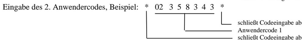
Nach korrekter Eingabe der beiden Anwendercodes, (siehe auch unter **Programm 1: UnterCodes**) wird das Schloss aufgefahren.
